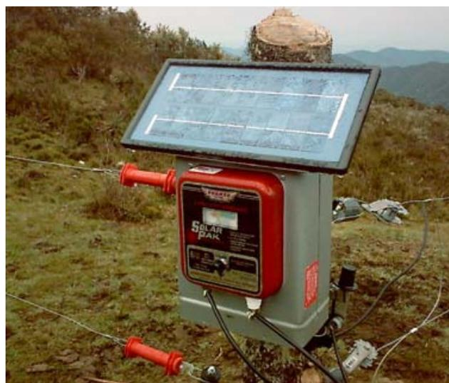
**Fig. 10.** Mediante el uso de un panel de celdas solares, el corral electrificado se mantiene funcionando las 24 horas del día los 365 días del año.
