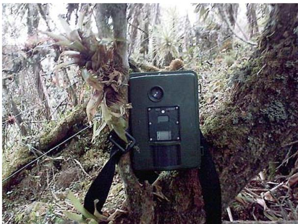
**Fig. 11.** Para monitorear la presencia del oso frontino, así como de cualquier otro animal en las cercanías del corral, hemos instalado 4 cámaras fotográficas de activación automática que funcionan con un sensor infrarrojo.
